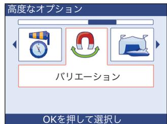
2. **OK**を押して、**バリエーション**設定ボックスを表示します。これには2つの調整ボックスがあり、変動モードを示す上段のボックスと変動値を示す下段のボックスがあります。
