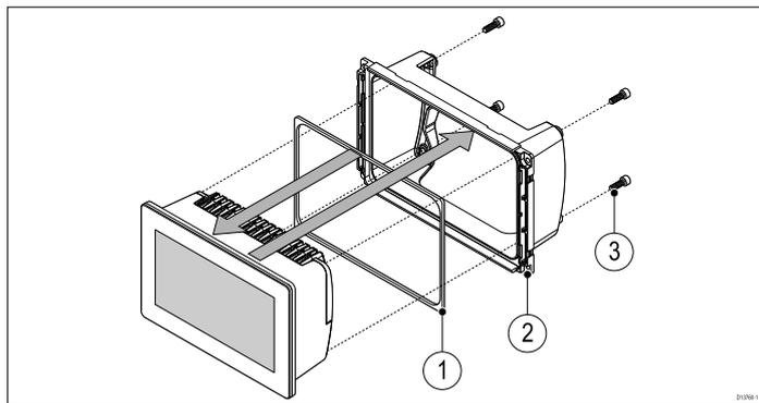
1. ガスケットからバックリングを取り外し、MFDの背面に取り付けます。黒い柔らかい面がMFDに面していることを確認します。
