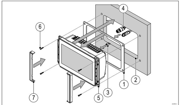
1. 前面取り付けキットに付属のガスケットから裏材を取り外し、MFDアセンブリの背面に取り付けます。黒い柔らかい側面がアセンブリの背面に面していることを確認します。
